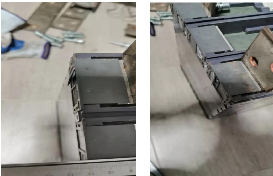
图 6 断路器底壳顶穿实验
